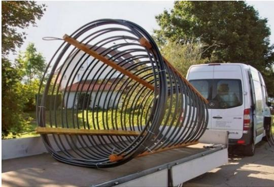
Für eine Wärmequelle auf engerem Raum könnten sogenannte Erdwärmekörbe sorgen. Dies sind vorgefertigte Wärmetauscher, die auf relativ kleiner Fläche dem Erdreich Wärme entziehen können.
